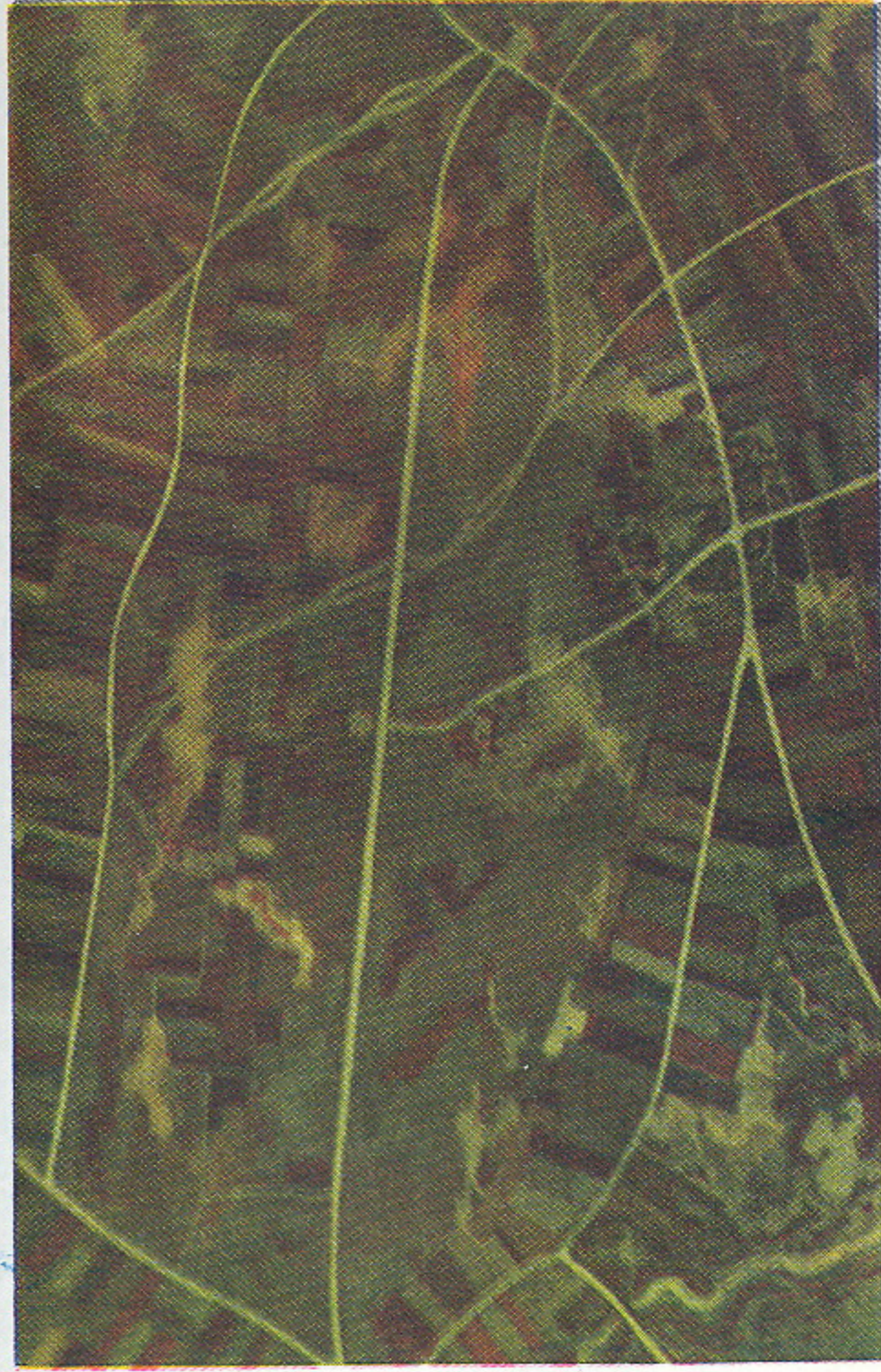
Sl. 159a Aerodrom posle maskiranja (betonske površine su kamuflažno obojene, a komandno-upravni objekti su primenom dekorativnog načina razbijeni na manje uočljive površine)
