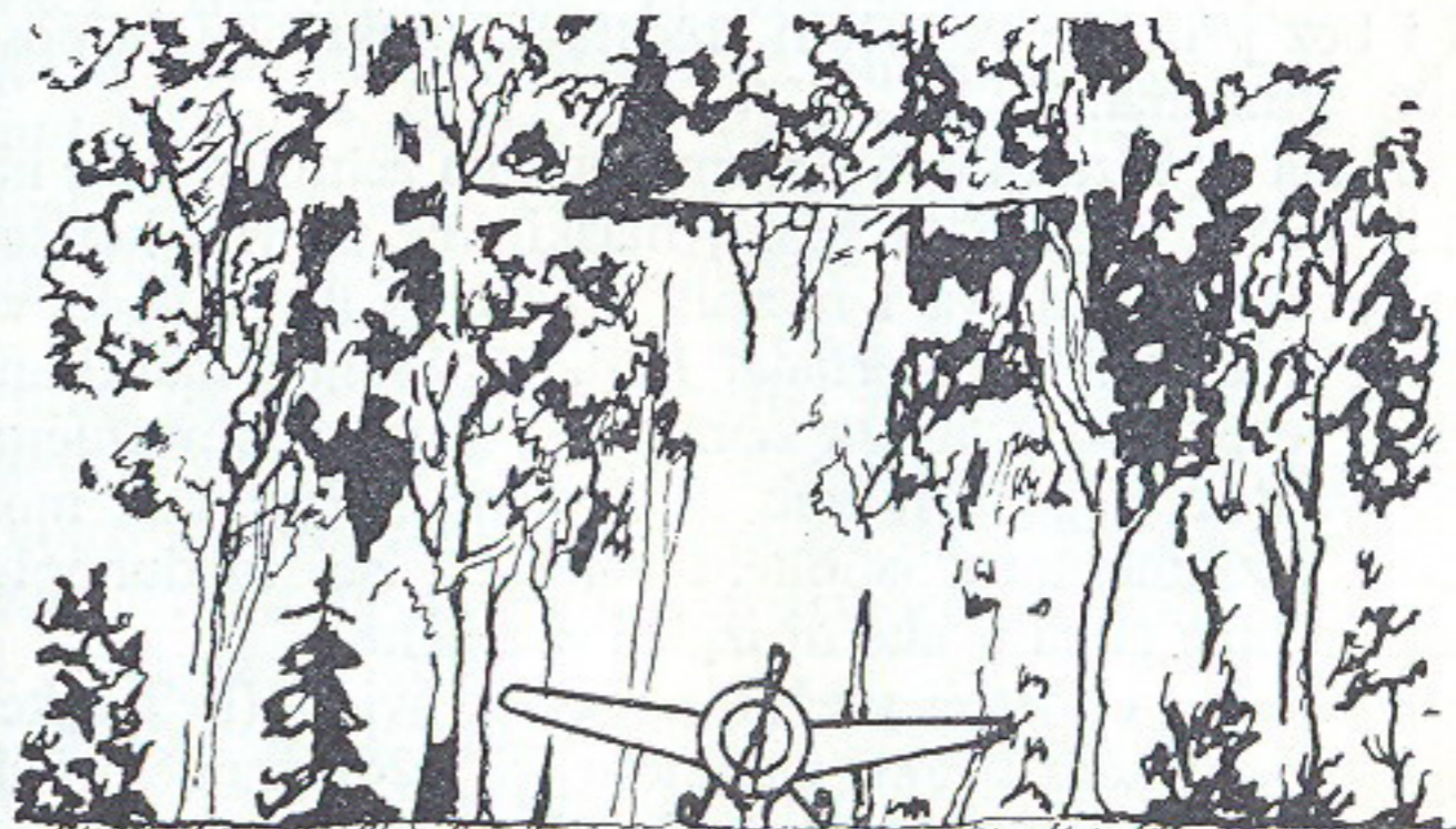
Sl. 124 Avion maskiran u retkoj šumi horizontalnom maskom od mesnih sredstava
